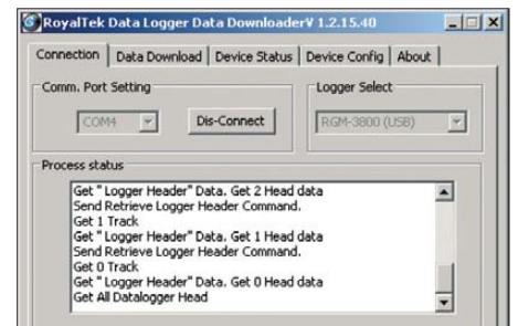
Bild 3: Die mitgelieferte Software übernimmt die Verbindung zum RGM-3800.
