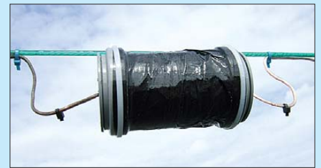
Bild 38: Ansicht einer gegen Witterungseinflüsse gesicherten Spule; die kleinen Kabelbinder auf den Antennendrähten zu beiden Seiten der Spule bewirken ein Abtropfen der am Draht entlang laufenden Regentropfen und halten diese von der Spule fern.
