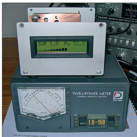
Bild 1: Ansicht des SWV-/Wattmeters während der Vergleichsmessung mit einem kommerziellen Gerät
