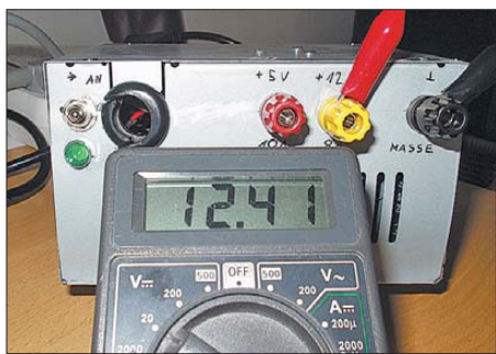
Bild 1: Das PC-Netzteil liefert auch unter Last Spannung mit ausreichender Toleranz.
