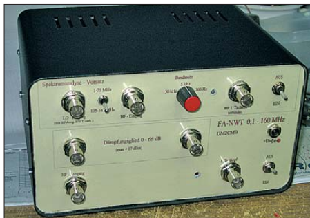
Bild 1: Zusammen mit dem vom FA-NWT steuerbaren Dämpfungsglied erhält man einen kompletten HF-Messplatz; hier der Aufbau von Rainer, DM2CMB. Ein ähnliches Gehäuse, das den NWT und alle derzeit existierenden Zusatzbaugruppen aufnehmen kann, befindet sich beim FA-Leserservice in Vorbereitung.
