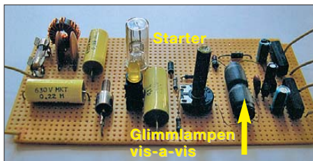
Bild 1: Aufbau des Zufallsgenerators auf einer Lochrasterplatte Fotos: Autor
