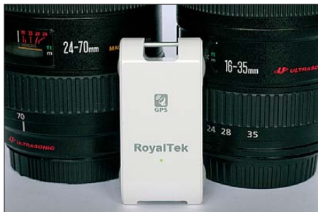
Bild 1: GPS-Logger wie der RGM-3800 speichern automatisch den Verlauf von Reiserouten.
