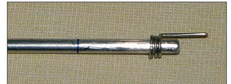
Bild 3: Bei einem Vollstab, hier ein 4-mm-Strahler einer Leichtbau-Yagi, kann ein Draht zur Verlängerung dienen. Fotos: DK7ZB
