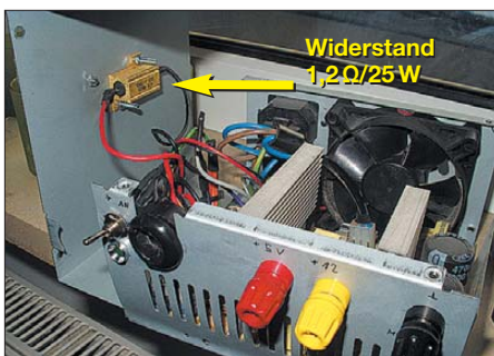
Bild 2: Der Anlaufwiderstand ist gut gekühlt zu montieren.
