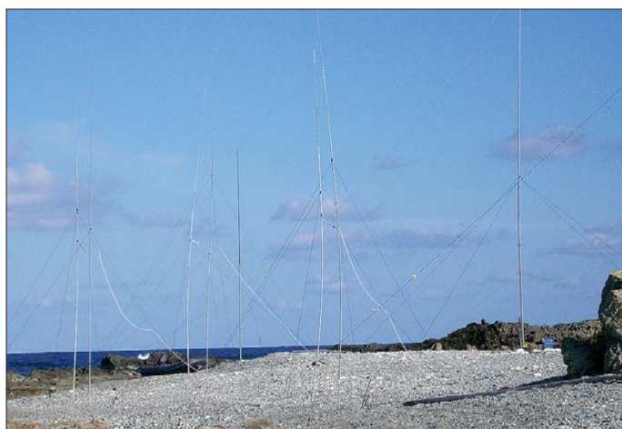
Nur ein kleiner Teil der umfangreichen Antennenfarm von K5D: Hier die in Richtung Nordamerika und Asien ausgerichteten Vertikaldipole am Strand von Desecheo
