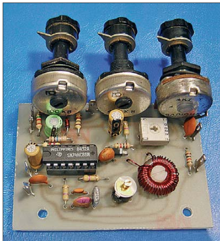
Bild 1: Ansicht des kompletten Wobbelzusatzes mit dem HCMOS-Schaltkreis
