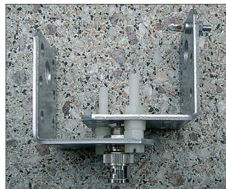
Bild 4: Rechts oben ist die Lötöse für die Verbindung des oberen Winkels mit dem Innenleiter des BNC-Einbausteckers zu sehen, unten die Kunststoffmuttern als Distanzstücke.
