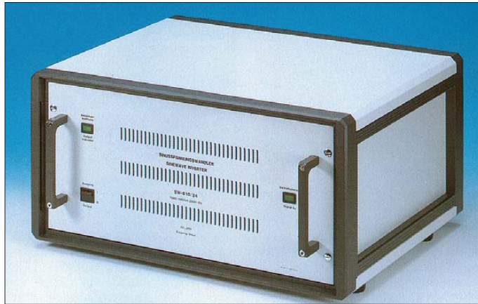
Bild 3: Sinusspannungswandler als Beispiel zur konkreten ergonomischen Gestaltung von Trage- und Einschubgriffen bei elektronischen Geräten; die Masse des Spannungswandlers beträgt 12 bis 30 kg. Für 30 kg sind die Tragegriffe von ihrer Dimensionierung her allerdings zu schwach bemessen.
