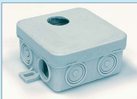
Bild 40: Diese Feuchtraum-Abzweigdose dient, mit insgesamt vier Löchern versehen, als Querträgerhalterung für einen GFK-Mast. Der Mast kommt durch die senkrechte Bohrung, der Querträger durch die waagerechte. Fotos: DG0KW (3), Red. FA (2)
