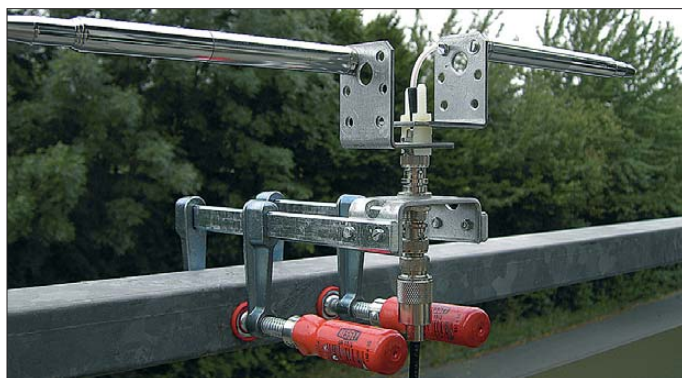
Bild 2: Diese Ansicht zeigt die beiden angeschraubten Antennenstäbe sowie die Verbindung zum Innenleiter des BNC-Steckers.
