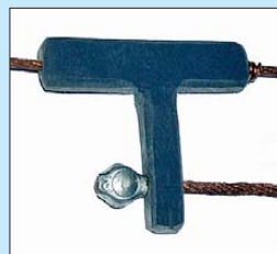
Bild 37: Variante des T-förmigen Abstandshalters am Ende von Draht 3
